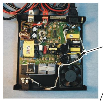
FOR 220VAC OPERATION, LIFT ONE END OF THE YELLOW JUMPER RUNNING BETWEEN PINS C & E ON THE PC BOARD.
