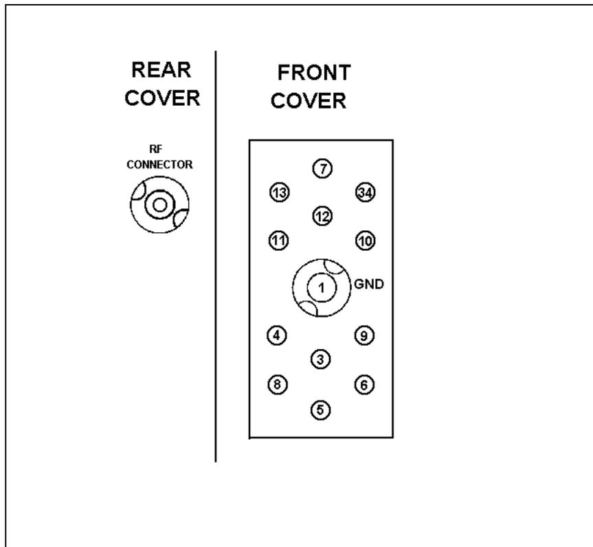
Figure 5 - UDC Pin-Out
