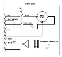
★ NOTE: DTMF MIC HANGER MUST BE GROUNDED TO YEHICLE GROUND (NEGATIVE GROUND YEHICLES SYSTEMS).
