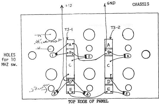
LAMP INSTALLATION PICTORIAL. VIEW IS FROM THE INSIDE OF THE FRONT PANEL.
