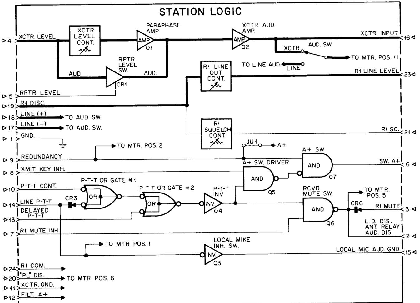
CR1 IS DIODE SWITCH. IT BYPASSES EXCITER LEVEL CONTROL AND PARAPHASE AMP.
